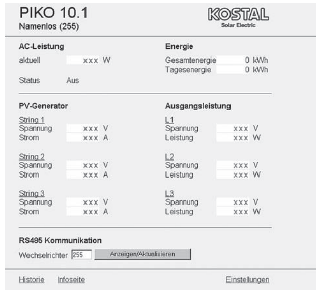
Figur 92: Webserverens hovedside (antallet af viste ind- og udgange kan variere afhængigt af apparattypen.)
